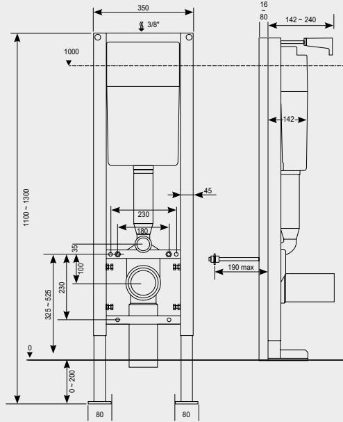
Bati-support avec structure autoportante résistant à une charge de 400 kg en époxy anti-corrosion.
